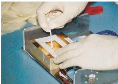
Prélèvement de contrôle microbiologique sur un équipement de la mission Mars 96 avant stérilisation (Photo CNES)
