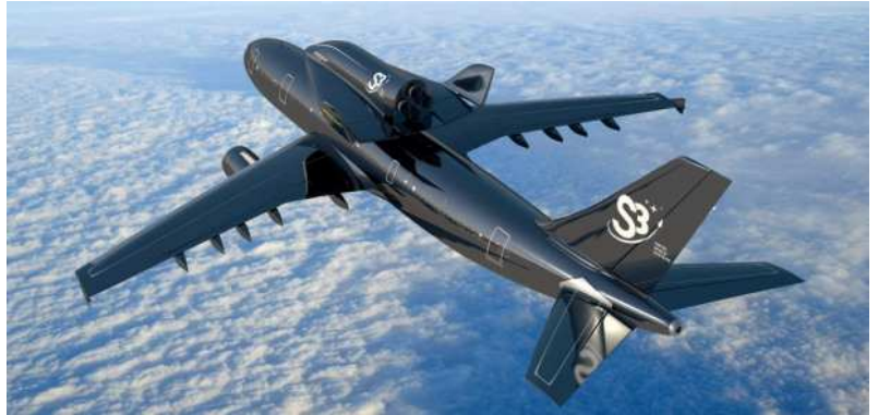
La navette SOAR sur le dos d'un airbus A300.
