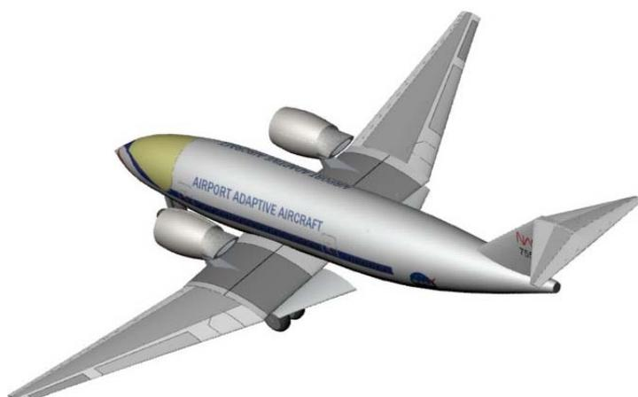
Sur ces illustrations, on remarquera que les déflecteurs ont pour fonction d'étendre au mieux les flux des gaz chauds éjectés des réacteurs afin de « mouiller » une surface maximum, et ainsi générer un supplément de portance appréciable. C'est pourquoi l'on peut remarquer sur la vue globale ci-contre, une surface amovible déployée uniquement durant les phases de décollage et d'atterrissage telle que le « prophétise » la NASA pour les années 2025.
