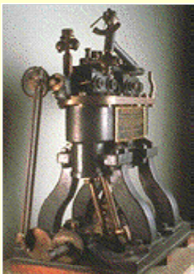
Premier moteur à quatre temps de Forest monté sur le bateau Jolie Brise (1888). (Musée des Arts & Métiers).
