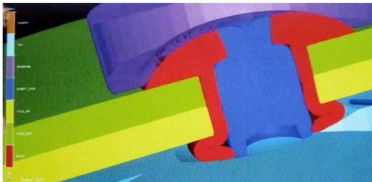
Simulation de déformations mécaniques lors de la pose d'un rivet
