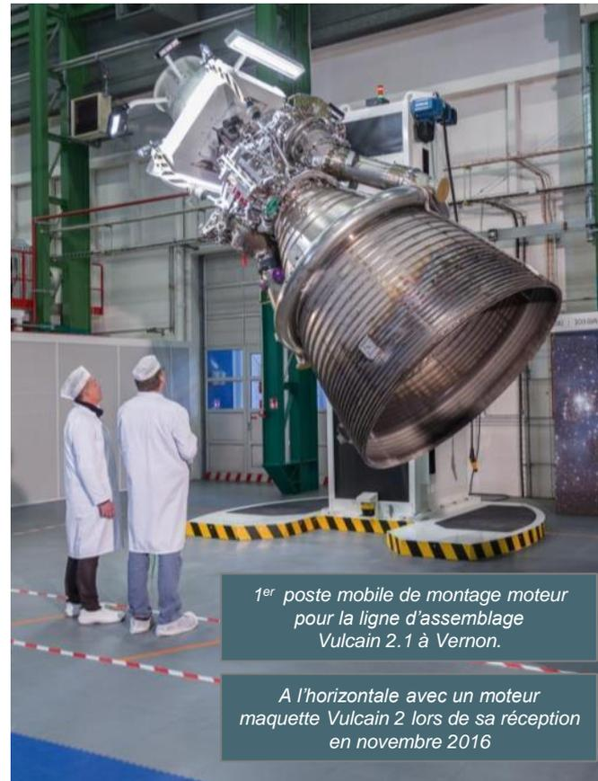
1<sup>er</sup> poste mobile de montage moteur pour la ligne d'assemblage Vulcain 2.1 à Vernon.
